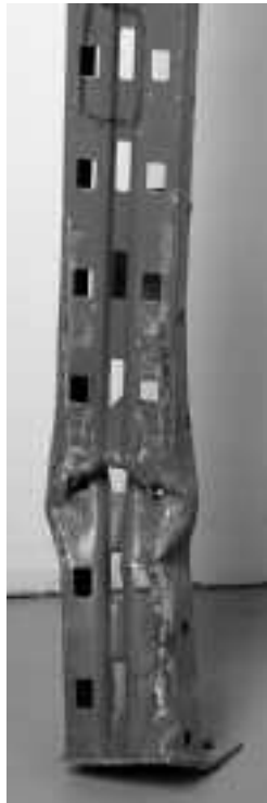
Figure 51a. Montant endommagé par des impacts répétés dans le sens latéral et frontal (Vue de face)
