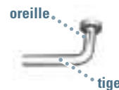
Figure 32b. Modèle de goupille de sécurité recommandé (Illustration : Technirack)
